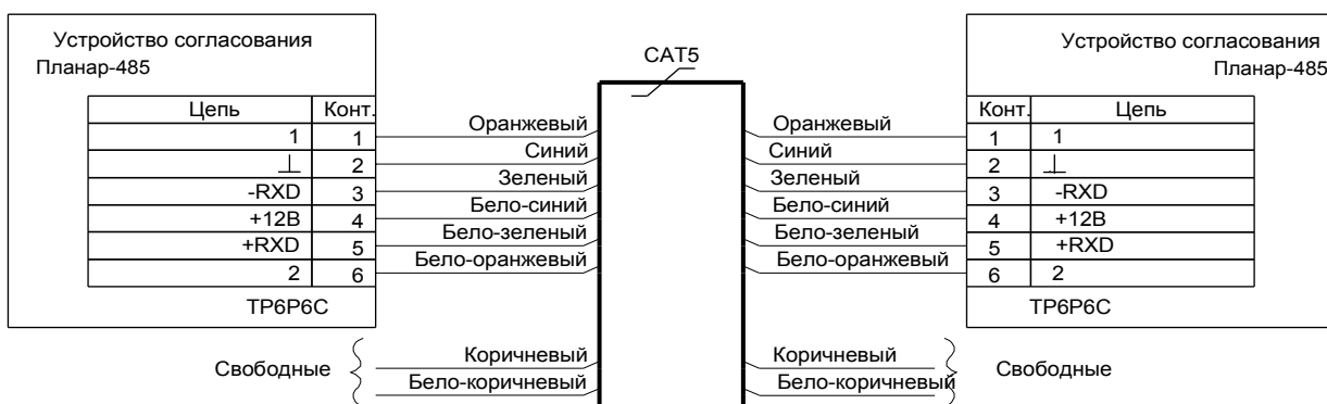
Рисунок 10 схема кабеля для соединения двух устройств согласования «Планар-485».
